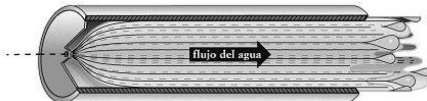
FIGURA 23. El agua que entra en una manguera a través de un orificio de su boquilla se expande primero en tres dimensiones antes de trasladarse sólo a lo largo de la única dimensión larga de la manguera.
